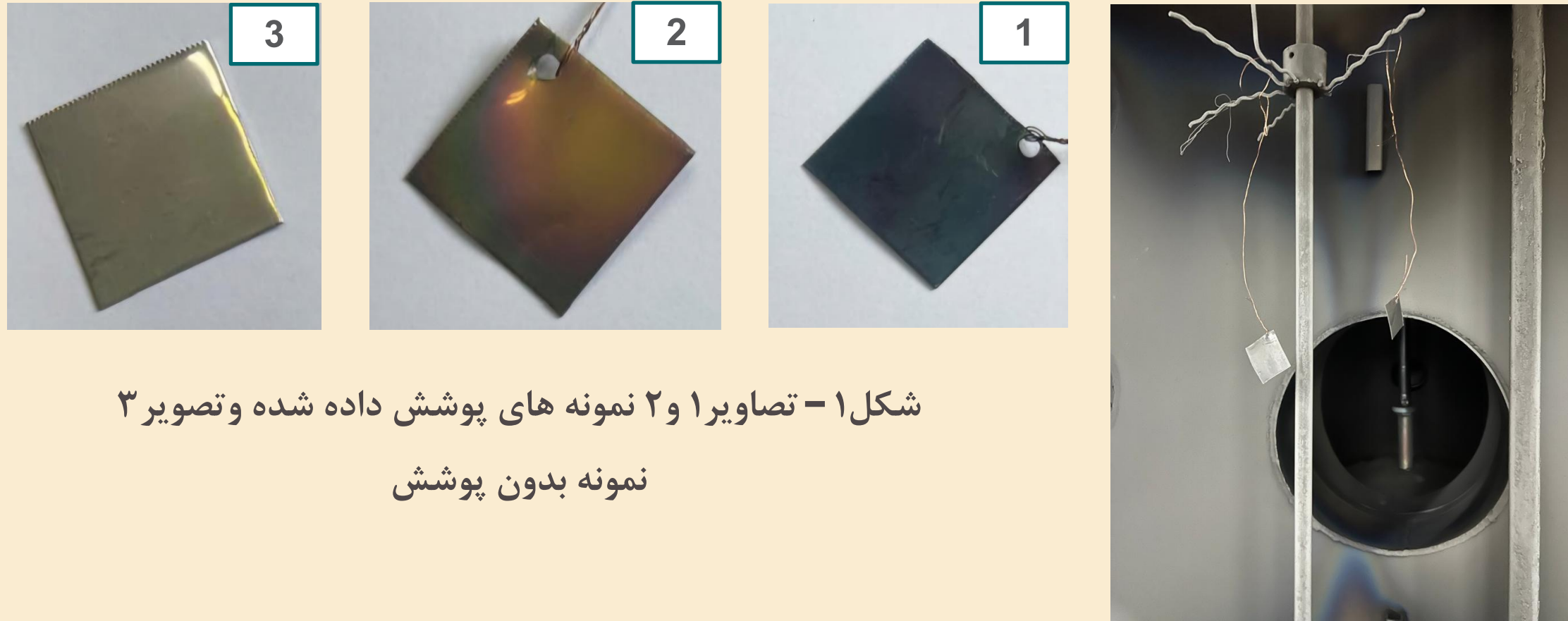
شکل ۲- نحوه ی قرارگیری نمونه‌ها در دستگاه Arc-PVD
